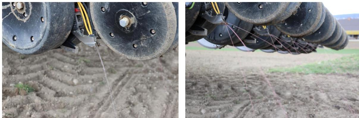
**Abbildung 20:** FurrowJet-Flüssigdüngersystem, das für die Aussaat auf der Versuchsparzelle verwendet wurde.
