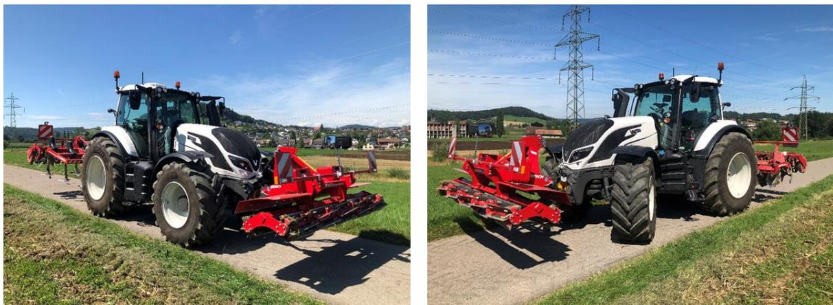
**Abbildung 25:** Kombinationen aus Messerwalze und Grubber (links) und Messerwalze und Kurzscheibenegge (rechts), die für die Versuchsparzelle verwendet wurden.
