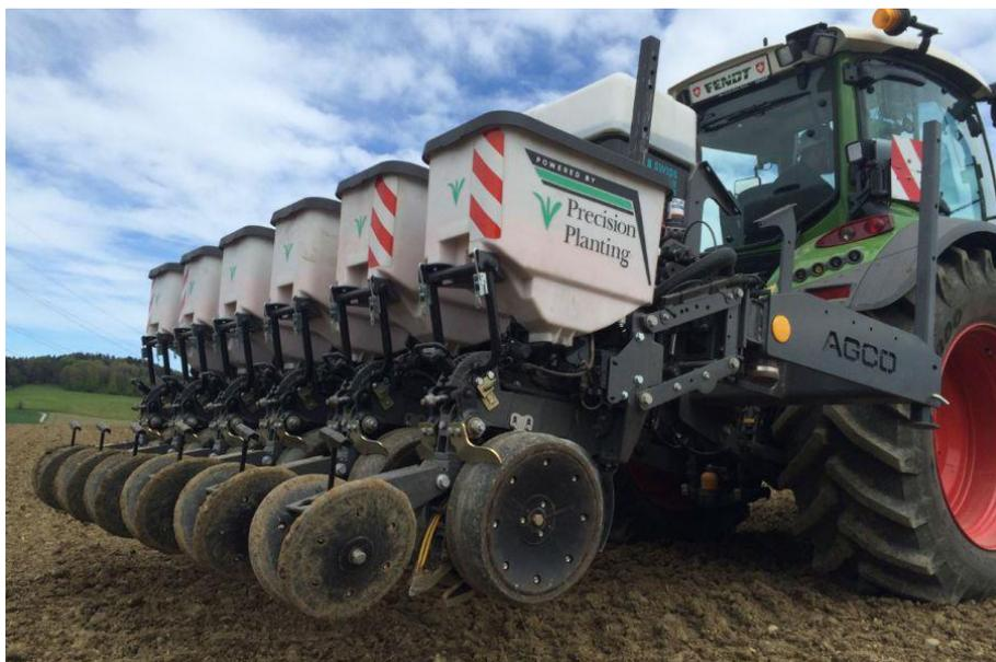
**Abbildung 13:** Precision Planting Einzelkornsämaschine mit DeltaForce-Schardruck-Regelung und Fendt 516 mit RTK VarioGuide, die für die Aussaat auf der Versuchspartelle verwendet wurden.
