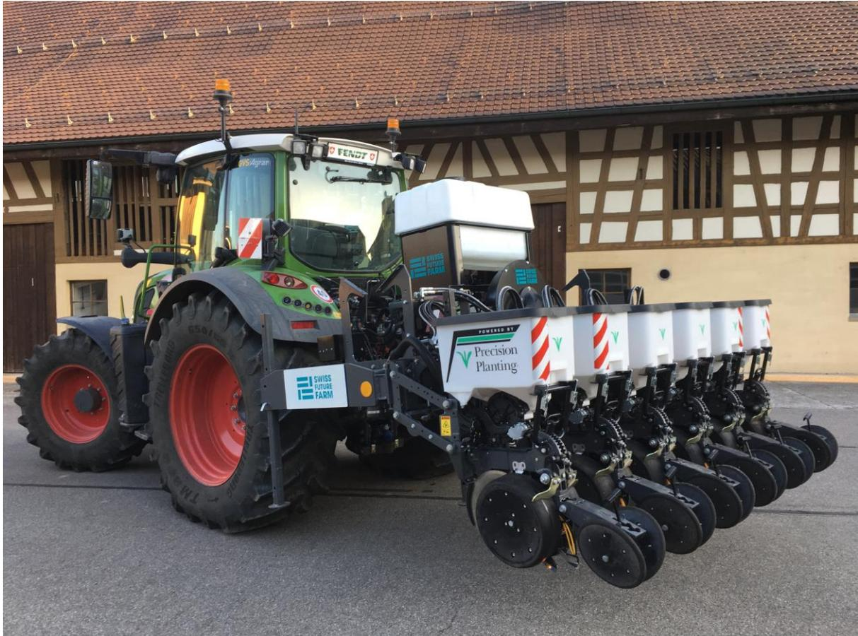
**Abbildung 9:** Precision Planting Einzelkornsämaschine mit neu aufgebautem Flüssigdüngersystem zur Zuckerrübensaat 2019 auf der Swiss Future Farm.
