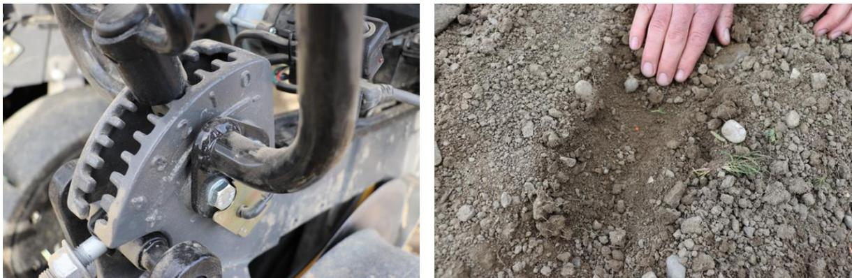
**Abbildung 14:** Einstellung der Ablagetiefe an der Sämaschine (links) und manuelle Kontrolle der Saatgutablage (rechts).
