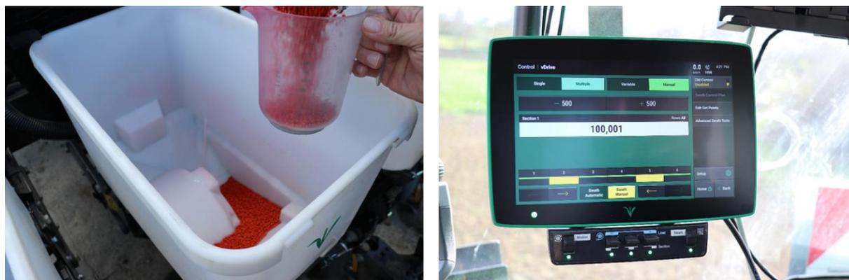
**Abbildung 17:** Zuckerrüben-Saatgut (links) und 20/20 Gen3-Terminal zur Einstellung der ausgebrachten Saatgutmenge (rechts).
