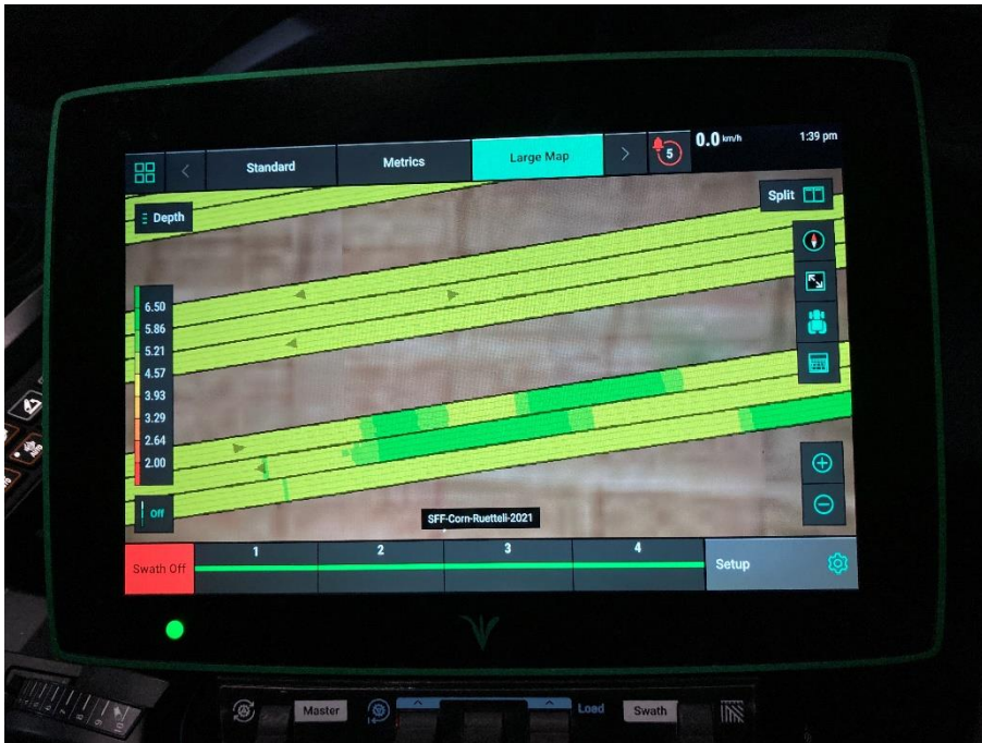
Abbildung 24: Einheitliche Standard-Ablagetiefe (oben) und variable Ablagetiefen (unten) auf der Versuchsfläche des Swiss Future Farm 2021 Ablagetiefen-Versuchs bei Silomais, dargestellt im Precision Planting 20/20 Gen 3 Terminal.
