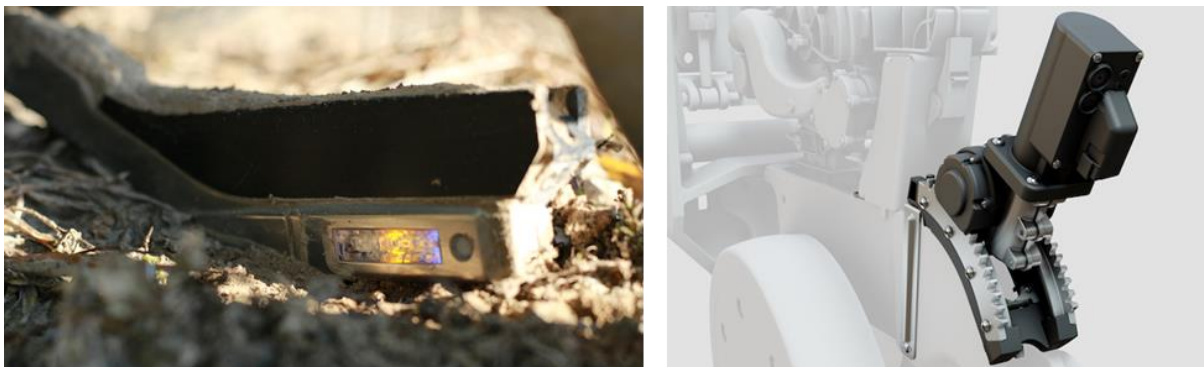
Abbildung 51: Precision Planting SmartFirmer zur Messung der Bodenfeuchtigkeit in der Furche (links) und Precision Planting SmartDepth zur Echtzeit-Anpassung der Pflanztiefe an den Feuchtigkeitsgehalt des Bodens (rechts).
