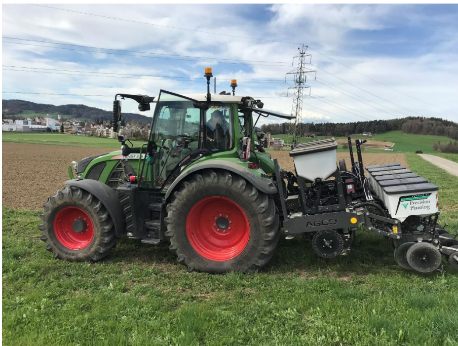
Abbildung 39: Einzelkorn-Sämaschine mit DeltaForce-Schardruck-Regelungssystem auf der Versuchsfläche.
