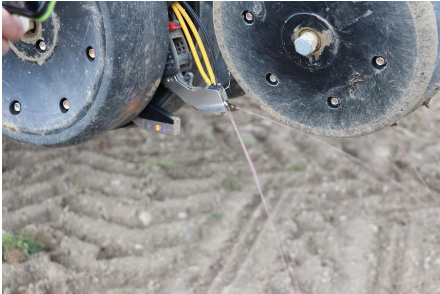
Abbildung 45: Precision Planting-Säaggregat mit FurrowJet-Flüssigdüngersystem für die Aussaat der Versuchsparzellen.
