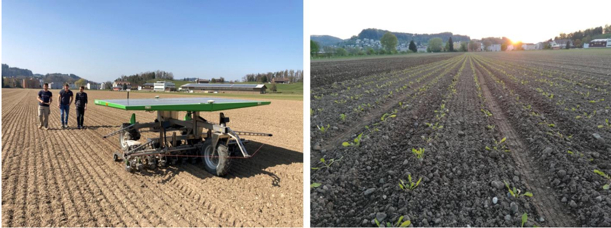
Abbildung 8. FarmDroid FD20 Feldroboter beim Säen von Zuckerrüben (links), Setzrüben am Tag des Pflanzens (rechts) auf der Versuchsfläche des SFF 2022 Robotik- und Setzrüben-Versuchs bei Zuckerrüben.
