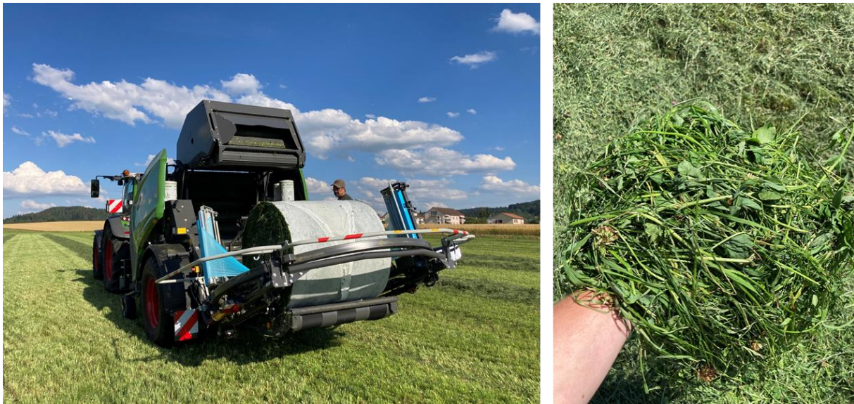
Abbildung 83. Rundballenpresse Fendt Rotana 130 F Combi mit Folienbindung (links) und leguminosenreicher Grünland-Bestand auf der Versuchsfläche (rechts).
