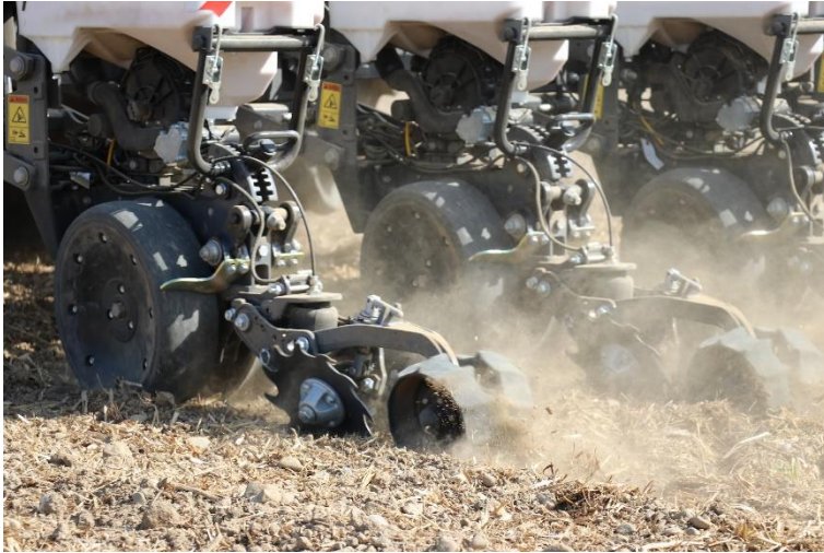
Abbildung 31. FurrowForce-Andruckrollensystem von Precision Planting an der Reiheneinheit der Sämaschine.
