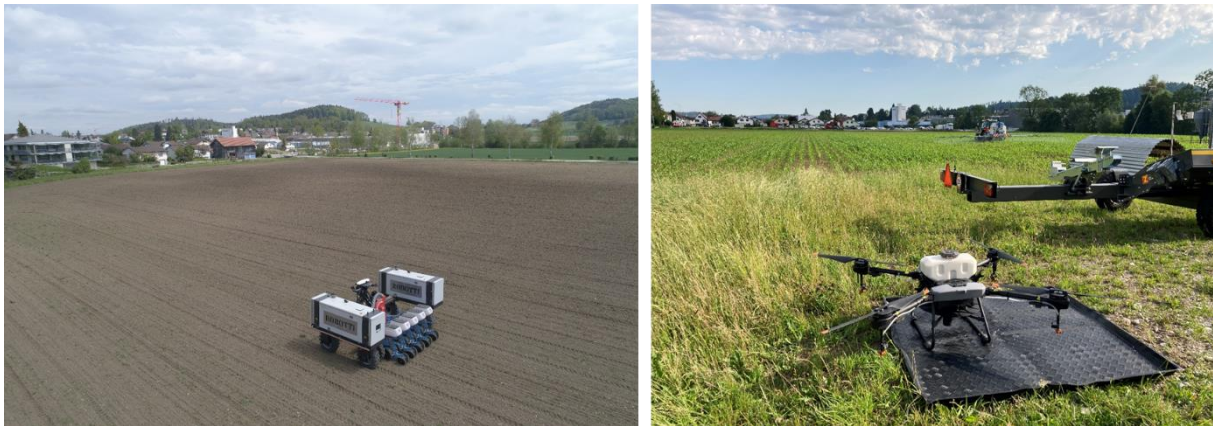
Abbildung 56. Agrobot 150D Feldroboter mit Einzelkornsämaschine (links), DJI Agras T10 Drohne mit Sprühgerät (rechts) auf der Versuchsfläche des SFF 2022 Robotik- und Autonomie-Versuchs bei Silomais.
