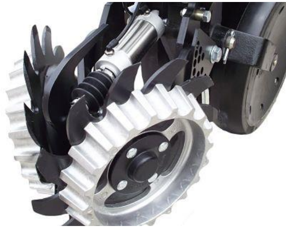
Abbildung 23. CleanSweep-Furchenräumer-System von Precision Planting an der Reiheneinheit der Einzelkornsämaschine.
