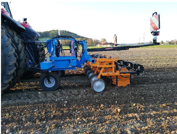
Abbildung 1. Kameragesteuerte Hacke zur mechanischen Unkrautbekämpfung auf der Versuchsfläche des SFF 2022 Unkrautbekämpfungs-Versuchs in Zuckerrüben.
