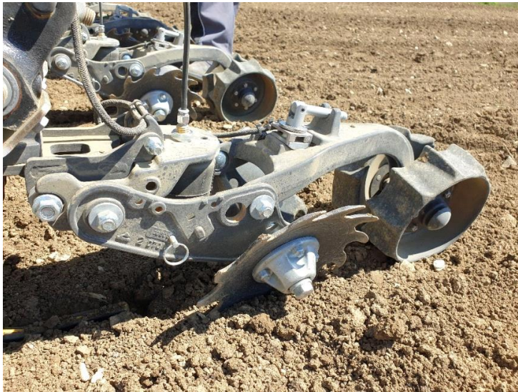
Abbildung 36. Das pneumatische Andruckrollen-System Precision Planting FurrowForce ermöglicht es, die Bodenfeuchtigkeit zu erhalten und Erträge unter schwierigen klimatischen Bedingungen zu sichern.
