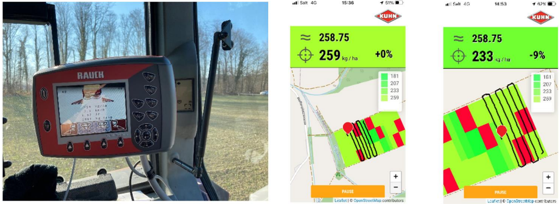
Abbildung 97: Düngesteuerer mit manueller Schaltung am Terminal inkl. der Smartphone-App zur Orientierung auf dem Feld
